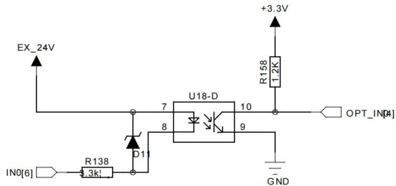
为保证信号接收正常低电平时电流必须大于 2.5mA, 即  $V_{CC}-V_{inL}>8V$ , 如果供电电源电压为 24V,  $V_{inL}$  要小于 15V.
